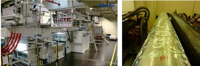
Die Druckvorbereitung gewährleistet einen reibungslosen Produktionsablauf. Hier werden kleine Reparaturen an den Druckwalzen vorgenommen. Die Hauptaufgabe ist jedoch die Produktionsvor- und Nachbereitung vom Druckequipment für die Produktionsprozesse.
